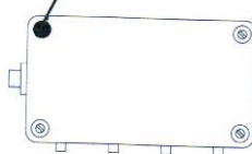
Рисунок 3 — Схема пломбировки соединительной коробки
